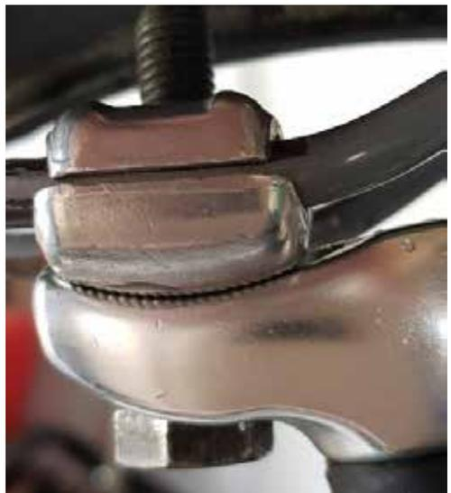
Befestigung der Sattelanbindung mit ersetzter Schraube
