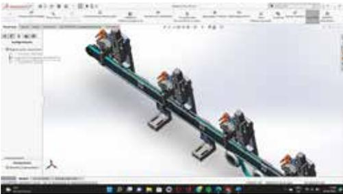
Mit der Montageanlage IM26G werden Einzelteile zu einem Scharnier für Klappensysteme hergestellt. Unsere Aufgabe ist eine Zuführung für eines dieser Teile zu konstruieren, die Federhülse. Momentan werden die Federhülsen mittels Förderbandes zugeführt, wobei das Problem besteht, dass durch die Bauteiltoleranzen und der Teilelage immer wieder Federhülsen übereinander laufen und Verklappen. Dabei entsteht hoher Aufwand für Entstörung der Zuführung, weil die Abdeckleisten demontiert werden müssen.
